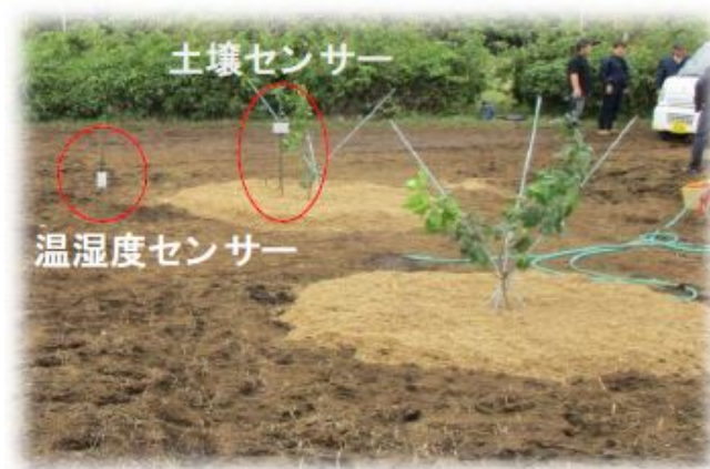
図2 温湿度センサと土壌センサの設置状況
